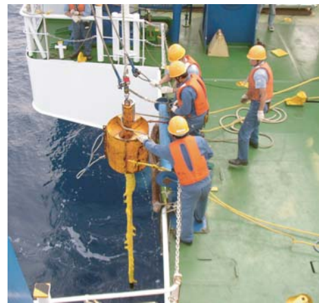
海域での熱流量測定 (この装置を堆積物に突き刺す)
