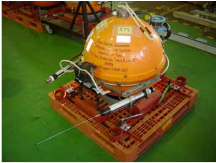
図2 広帯域海底地震計の外観、T09 に設置したもの。
