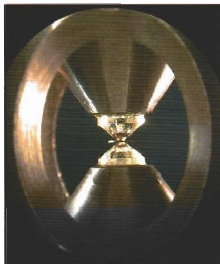
図1. radial diffraction実験用に側面が大きく開いたダイヤモンドアンビル装置
