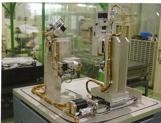
図1 SPring-8に導入し、調整をすすめつつある放射光X線単色化装置
