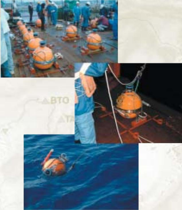
図4 フィリピン海横断測線で使用した長期型海底地震計。甲板上の15台（上）、設置直前（中）、7ヶ月間の観測後に浮上したところ（下）。
