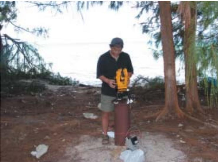
図 2 マジュロ島 (マーシャル諸島共和国) における地磁気絶対測定。このような測定を年 1 回実施することにより、地磁気永年変化を捉えることが可能になる。
