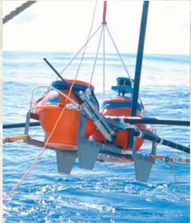
図4 フィリピン海の機動観測を終え、回収される海底電磁力計（OBEM）
