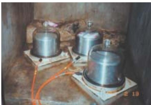
図2 パラバト（インドネシア）観測点に設置したSTS-1型広帯域地震計の概観。地震計は温度変化の影響を抑えるため、入り口から3枚のドアに仕切られた、地震計台に設置されている。
