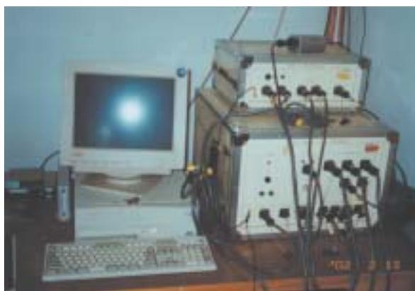
図3 パラバト（インドネシア）観測点に設置した海半球地震観測システムの外観。システムは海半球ネットワーク計画により開発され、ほとんどすべての海半球地震観測点に設置された。
