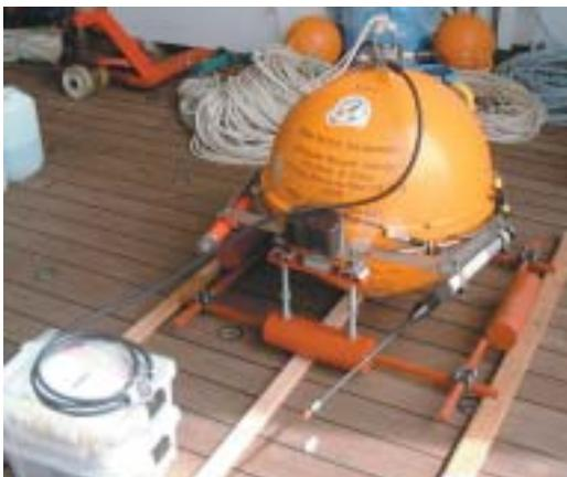
図2 設置前の広帯域海底地震計NWPAC2 (Jamstecの「みらい」船上)。
