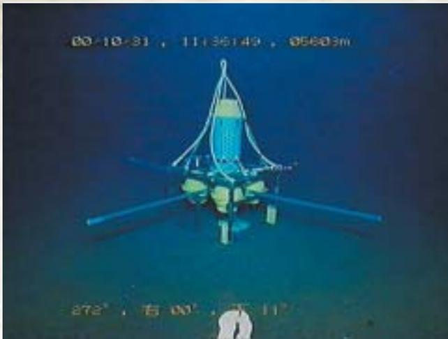
図3 北西太平洋の深海底（水深5600m）に設置された海底長期地磁気観測装置（海洋科学技術センター無人深海調査船「かいこう」で撮影）
