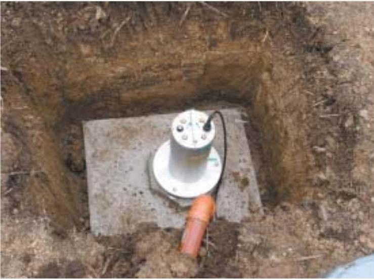
図 1 マンテンルパ (フィリピン) 観測点のOHP磁力計システムのフラックスゲート磁力計 (設置直前の様子)。
